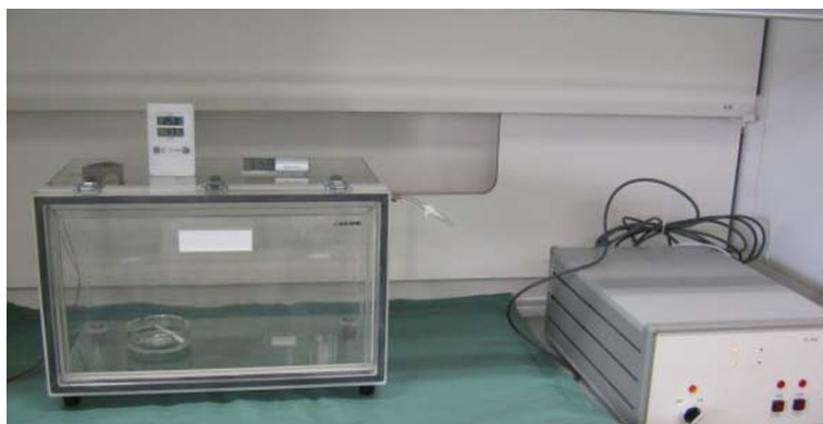
実験装置の全景（左：攪拌ファン・温湿度計・時計・検知管接続ポートを備えたアクリルボックス／右：電源装置）
